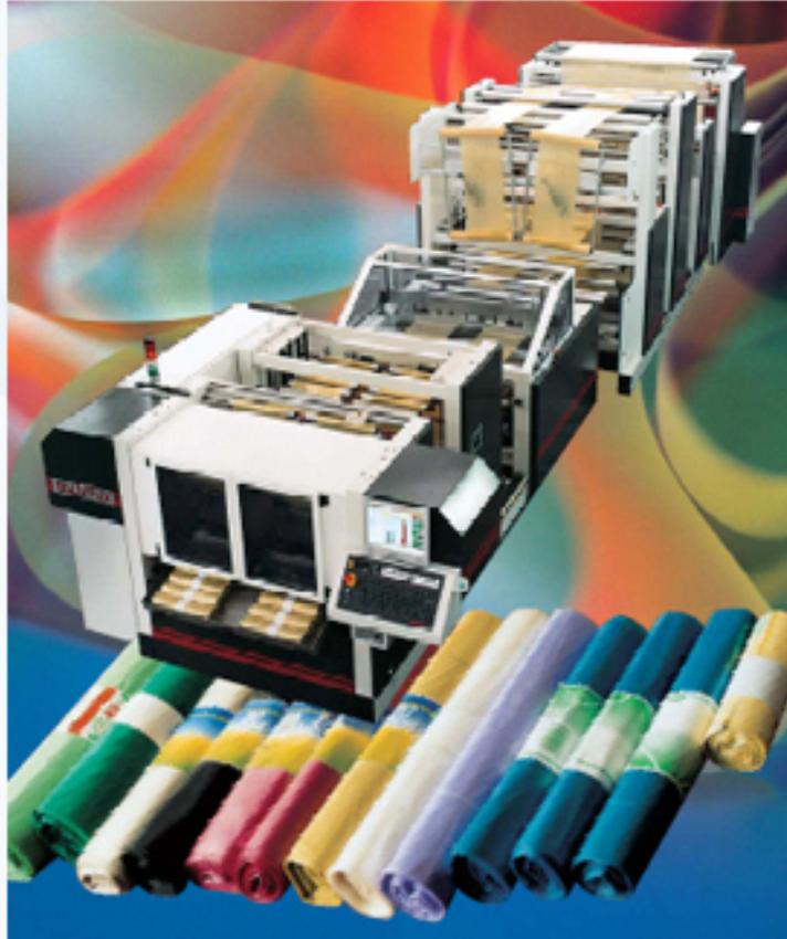
Le bobine vengono termosaldate per ottenere rotolini di sacchi per rifiuti.
