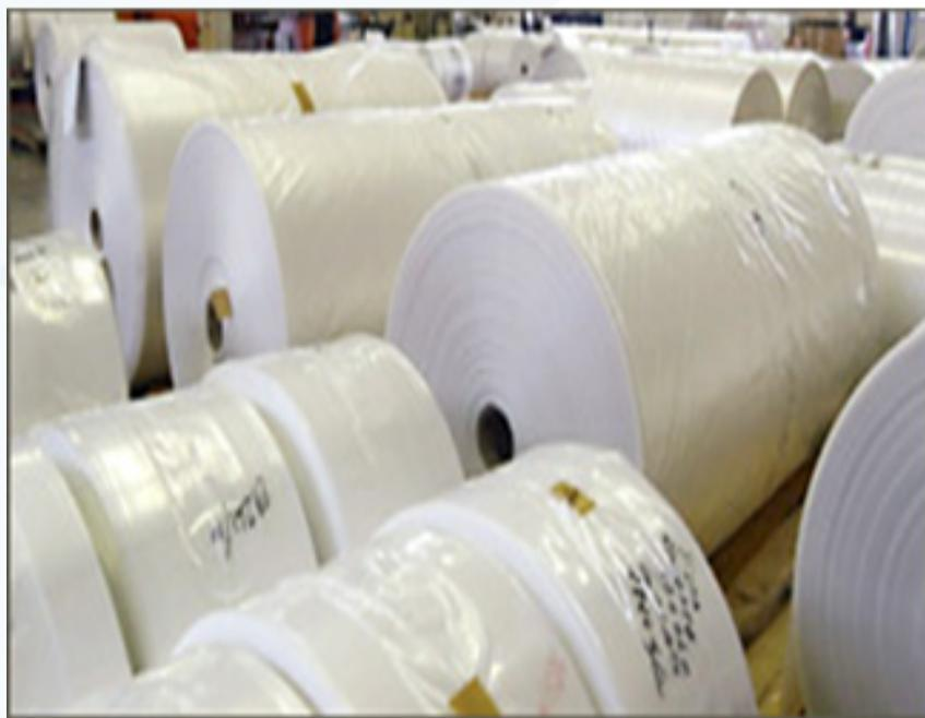
Il granulo viene estruso e il film raccolto in forma di bobine
